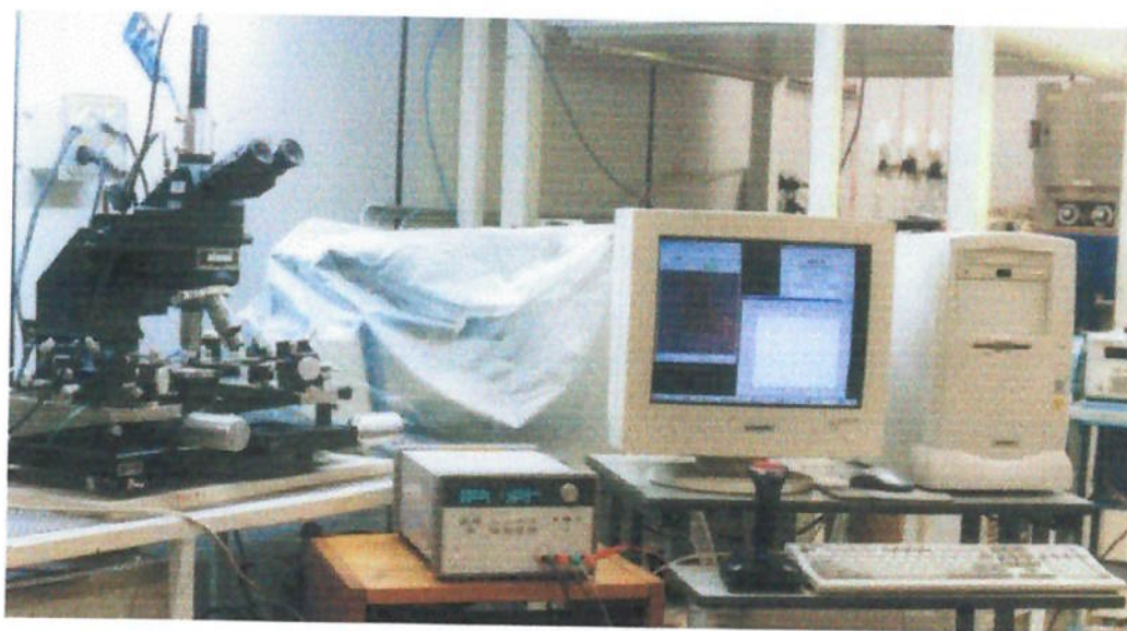
Fig. 3.8 - Equipamento usado no comando da fonte DC por “joystick”
